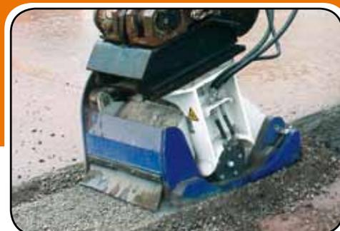
Ширина фрезерования варьируется от 30 до 60 сантиметров, а глубина - от 0 до 19 сантиметров, при использовании фрез EX60 или EX60 HD
