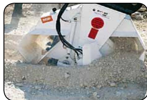
Обе модели могут поставляться с корпусом (опция), который обеспечивает удаление материала из траншеи и позволяет регулировать глубину фрезерования.
