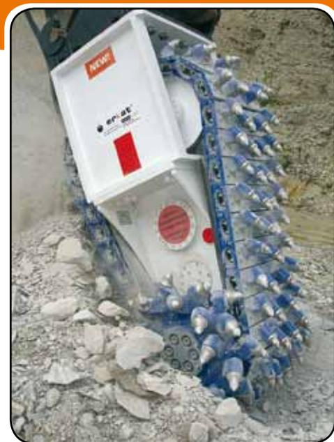
Фрезерная цепь, приводимая в движение режущими головками, фрезерует промежуточную часть между режущими головками, которая, в случае с обычными навесными фрезами, приводит к нежелательному расширению траншеи.
