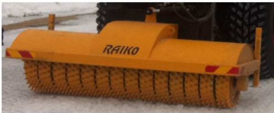
Рис. 5. Ледоскалывающая фреза T15
